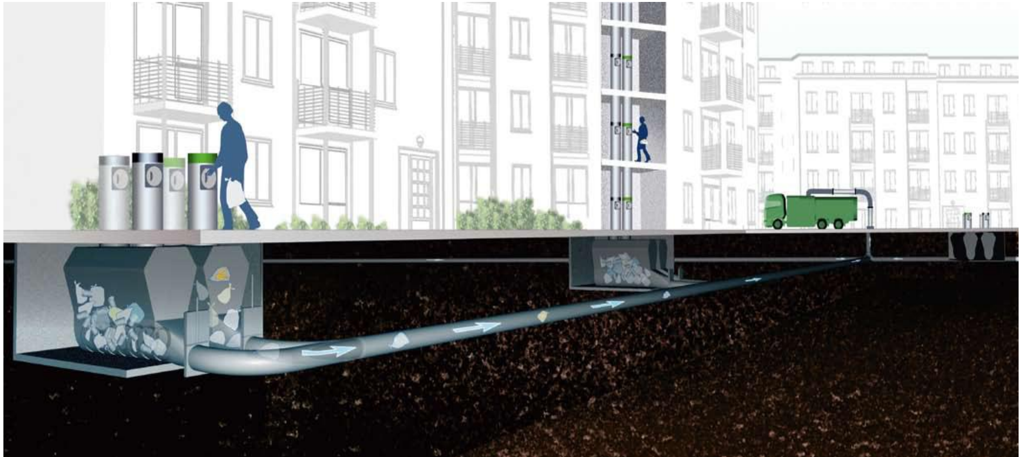
Εικόνα 42: Κινητό Σύστημα Πνευματικής Συλλογής Απορριμμάτων (Mobile Vacuum System)
