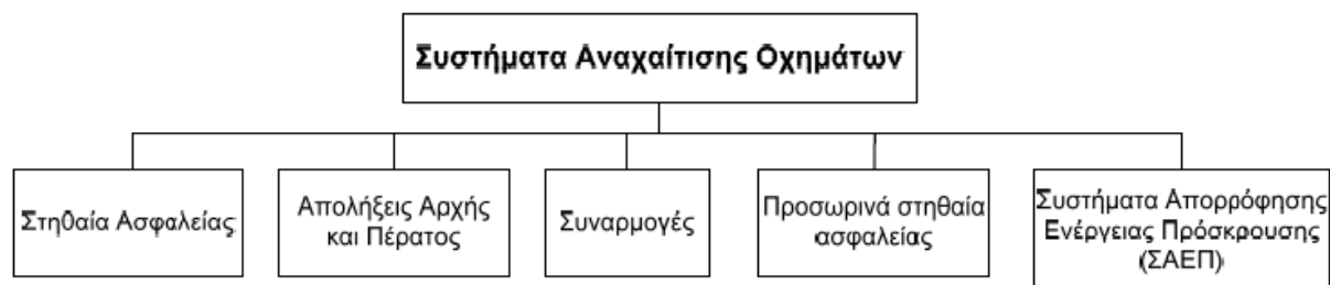
Σχήμα 4.7-1: Είδη συστημάτων αναχαίτισης οχημάτων
